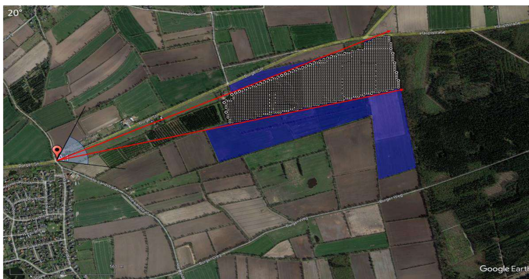
Abbildung 13: Vergleich Sichtfeld Fahrzeugführer für Punkt A1 mit Grenzvektoren in Richtung Module
