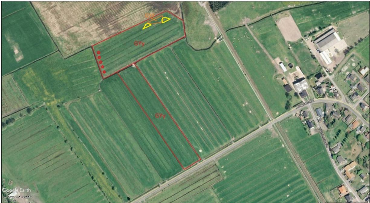
**Abb. 11: Maßnahmen in der Fläche Nr. 1 (rote Kreise: Gruppenstau durch Rohrknie; gelbe Flächen: ungefähre Lage der flächigen Gruppenaufweitungen (Blänken))**
